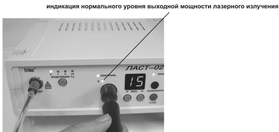
Рис. 10. Проверка соответствия уровня выходной мощности излучения.
