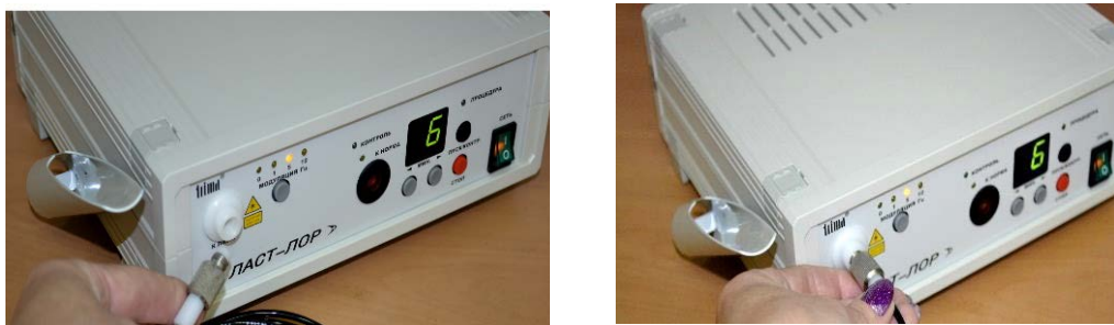
Рис. 9. Подключение световода к выходному гнезду К-лазерного модуля аппарата.
