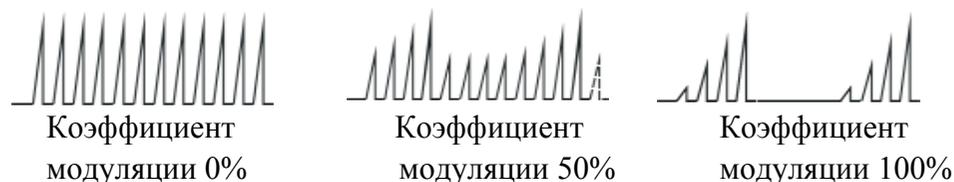
Модуляция ступенчатая (0,5; 1; 5; 10 Гц ), скважность 1:1
