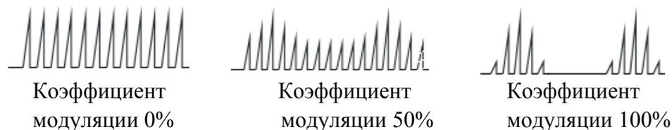
Рисунок 2. Формы токов индукторов при модуляции.
