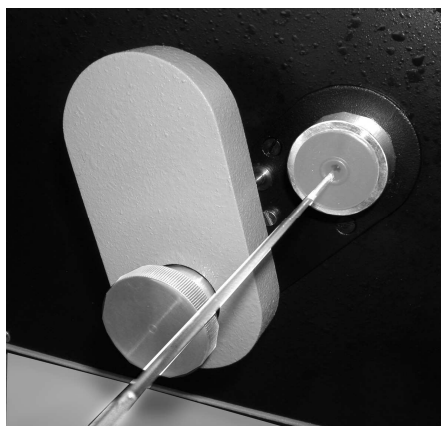
Рисунок 13 – Отбор пробы из стеклянного капилляра
