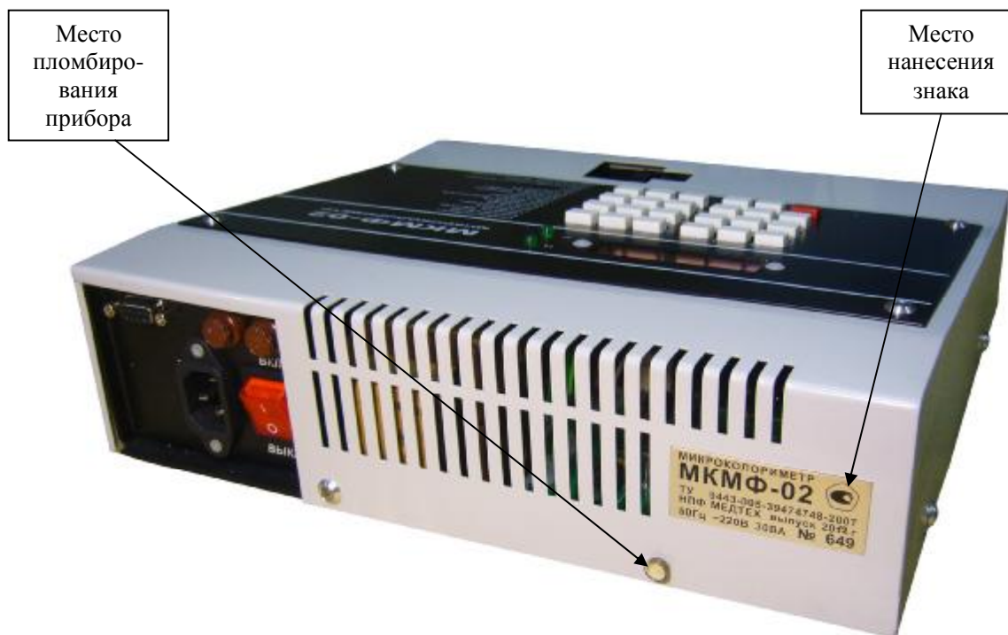
Рисунок 2 - Место пломбирования и нанесения знака утверждения типа
