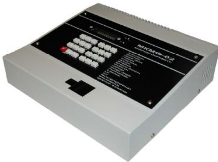
Рисунок 1 - Внешний вид микроколориметра медицинского фотоэлектрического МКМФ-02
